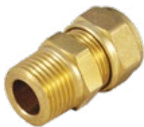
1100FD Raccordo diritto, dado e ogiva per tubo rame, filettatura maschio con sede piana per tubo acciaio corrugato e guarnizione piana
