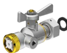
2284SPCK Robinet cu sfera pentru contoare, cu filet exterior conform ISO228, piulita semiolandez, cu posibilitate de purjare - Livrat cu supapa de retinere
