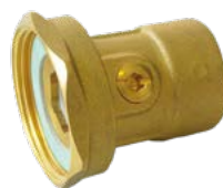
3889 Olandez pompa 1"1/2 cu robinet sfera inCorprat, actionabil cu cheie hexagonala cu filet 1" interior
