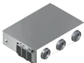
Ventilconvettore canalizzabile per gestione diretta multizona, motori con gestione elettronica ogni singola zona servita, in versione senza regolazione con controllo 0-10 Vdc per essere integrato con il sistema di termoregolazione Climav 2.0 Building Management o con regolazione remota diretta per singola zona. **Installazione orizzontale in controsoffitto.**
