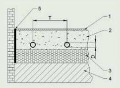
**Revestimiento superficial (1):** es el elemento de recubrimiento del sistema radiante a contacto con el ambiente. Las características térmicas del revestimiento son fundamentales a los fines de la potencia radiante que entrega el sistema, en verano e invierno. Un revestimiento a base de madera puede determinar la pérdida de una parte de la potencia disponible.
